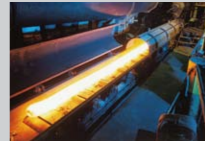
Auslauf des Profilstabs nach Verpressung durch eine formgebende Matrize
