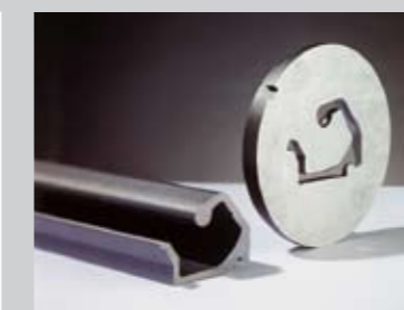
Formgebende Matrize und entsprechender Profilstab
