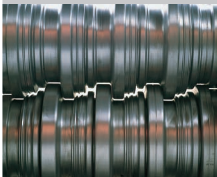
Kalibrierte Walzkörper zur Herstellung von warmgewalzten Spezialprofilen
